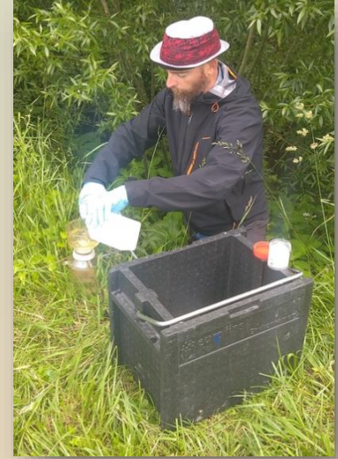
Aspiration au travers d'un filtre pour le saturer et l'analyser
